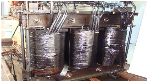
شکل (۶): افزایش دما و کاهش قدرت عایقی ناشی از اضافه بار طولانی مدت و متعدد
