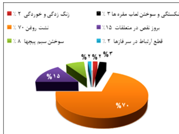
شکل (۱۹): نمودار درصد فراوانی عیوب نسبی ترانسفورماتورهای توزیع روغنی
