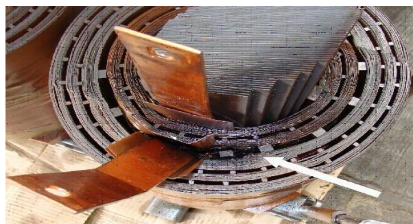
شکل (۴): اتصال سیم پیچهای فشار ضعیف و قوی
