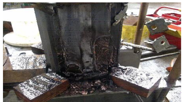
شکل (۸): اتصال سیم پیچ فشار ضعیف و هسته
