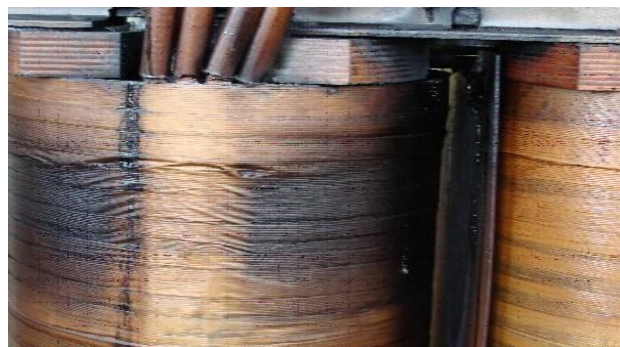
شکل (۵): افزایش درجه حرارت و کاهش قدرت عایقی
