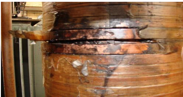
شکل (۲): اتصال حلقه در بوبین فشار قوی
