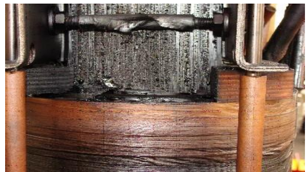
شکل (۱۲): افزایش چسبندگی روغن و کاهش گردش آن
