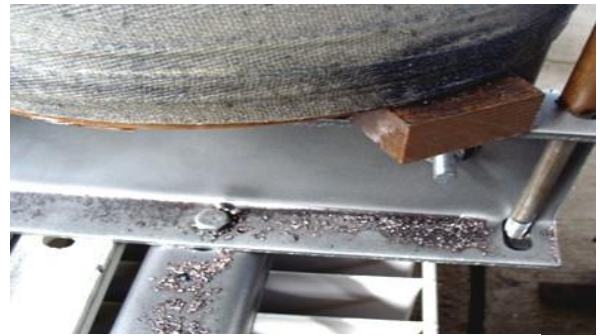
شکل (۱۱): ناخالصیهای رسانای تولید شده در مخزن ترانس
