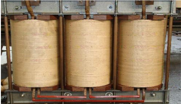
شکل (۱): اکتیو پارت در ترانسفورماتور
